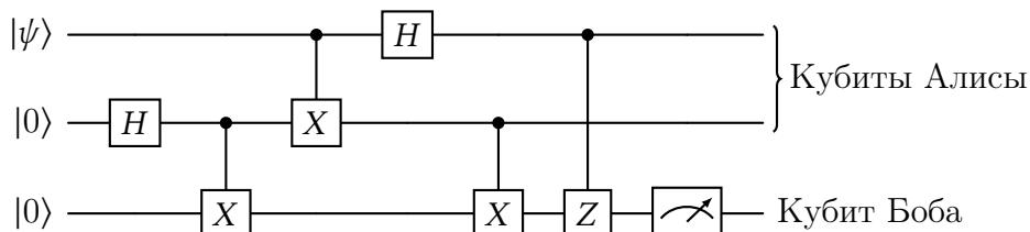
Проблема в том, что третий гейт CNOT должен быть реализован на этом огромном расстоянии. Запутанность не позволяет передавать информацию мгновенно. Хотя измерение одного кубита мгновенно определяет состояние другого, результат измерения является случайным и не может быть использован для передачи сигнала
