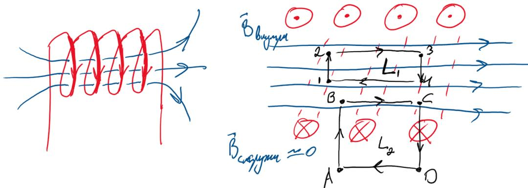
Получаем  $B = \mu_0 nI$  - поле катушки пропорционально плотности витков
